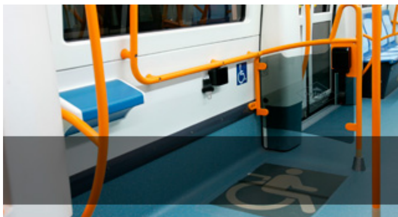
Aménagement intérieur de la zone PMR dans le métro de Madrid conçu par CAF
